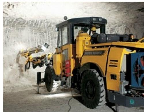
Станок снабжен одной стрелой **BUT 35** и перфоратором **COP**.
