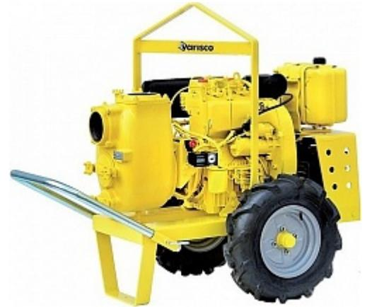
Насосы серии J производства VARISCO представляют собой самовсасывающие центробежные насосы с рабочим колесом открытого типа, способные перекачивать жидкости с содержанием твердых частиц большого диаметра за счет использования сменных компенсационных колец. Насосы имеют легко открывающиеся крышки для осмотра и механические уплотнения с внешней смазкой.
